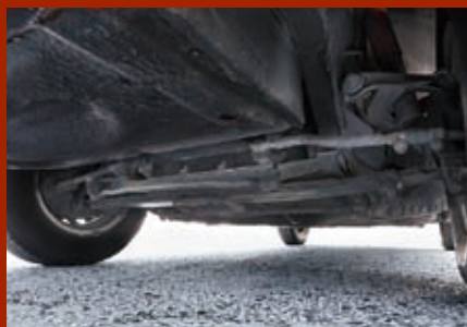
フロントの車体下を覗くと、アッパーアームの短さがよくわかる。しかしスプリング自体がダンパー的な機能も有するリーフスプリングを横置きするため、その乗り心地はとてよやさしい。
