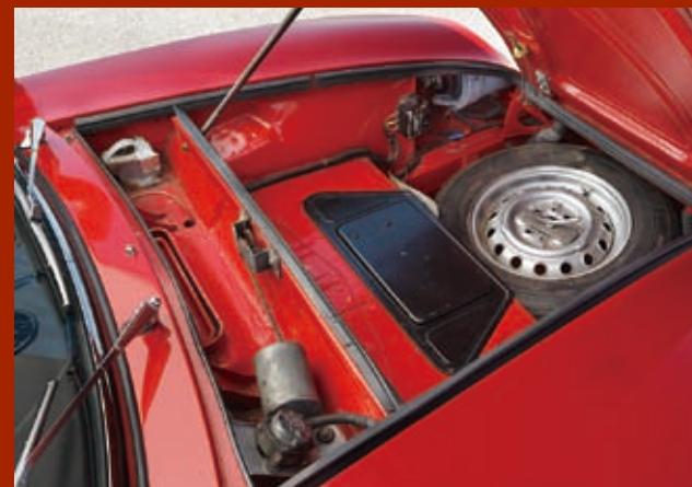
ボンネットスペースは、スタイリングからも想像できる通り開口部が広くて深さがあまりない。スベア・タイヤが蹴っこで寝かされているのは、衝突安全も考慮した結果だろう。燃料タンクはリアにある。
