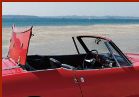
リアの鋼板製のトノーが開き、その下に幌がキレイに収まる。まるで現代の電動式ソフトトップ機構のようなカッチリとした作りこみだ。エンジンリッド用も兼ねるヒンジはスパイダーの専用品。
